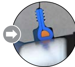
Disco en Posición Cerrada. Presión de línea aplicada desde la dirección del flujo preferida .
