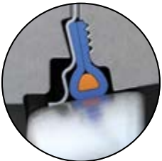
Sin presión de la línea. (Condición antes del evento de incendio.)
